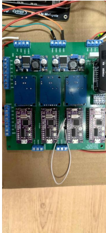
4. ábra A saját tervezésű motorvezérlő NYÁK a négy Arduino Nano-val, DC-DC konverterekkel, reléekkel és a CAN/motor csatlakozókkal.
